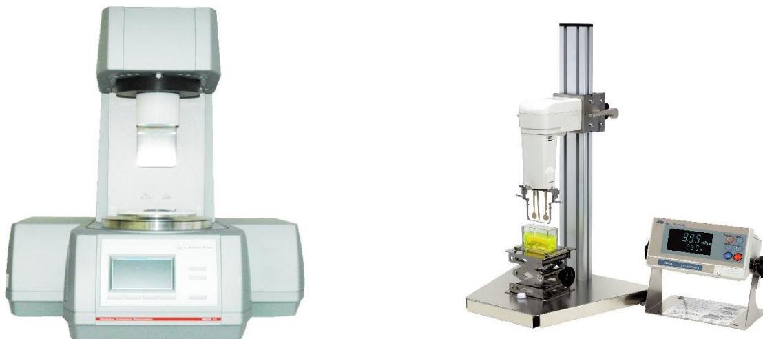
ภาพที่ 5.12 แสดงเครื่องวัดความหนืดของสารอาหารที่มีแป้งเป็นส่วนประกอบหลัก
