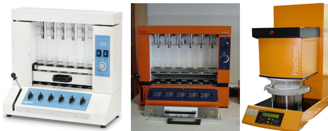
ภาพที่ 5.10 แสดงอุปกรณ์วิเคราะห์เยื่อใย ตามวิธีดีเทอร์เจนท์ (detergent method)
