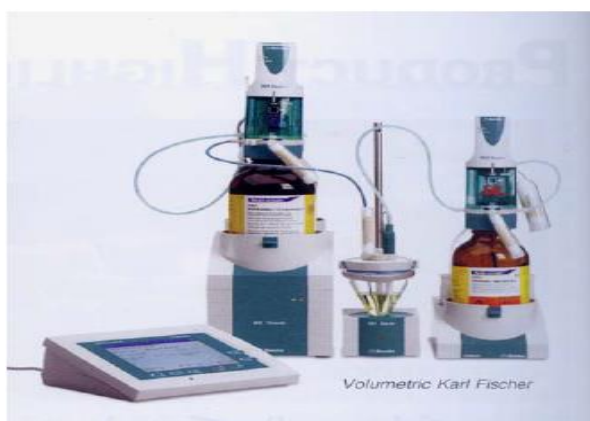
ภาพที่ 5.6 แสดงเครื่องมือวิเคราะห์หาความชื้นในอาหารระดับเปอร์เซ็นต์ ด้วยเทคนิค volumetric
