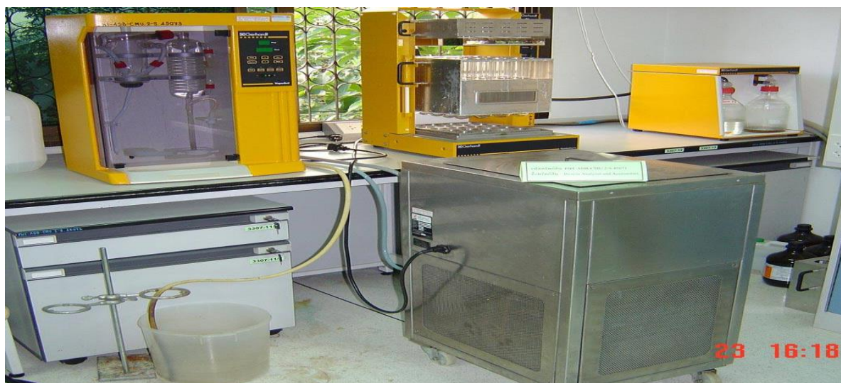
ภาพที่ 5.8 แสดงอุปกรณ์วิเคราะห์โปรตีนที่เรียกว่า kjeldahl method ประกอบด้วย 2 ส่วน คือ บล็อกย่อยและเครื่องกลั่น
