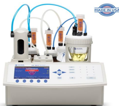
ภาพที่ 5.6 แสดงเครื่องมือวิเคราะห์หาความชื้นในอาหารระดับเปอร์เซ็นต์ ด้วยเทคนิค volumetric
