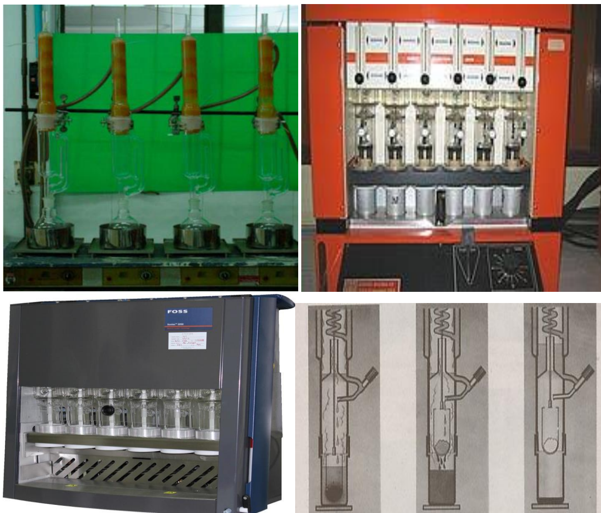
ภาพที่ 5.9 แสดงเครื่องวิเคราะห์ไขมัน และขั้นตอนการวิเคราะห์ไขมัน
